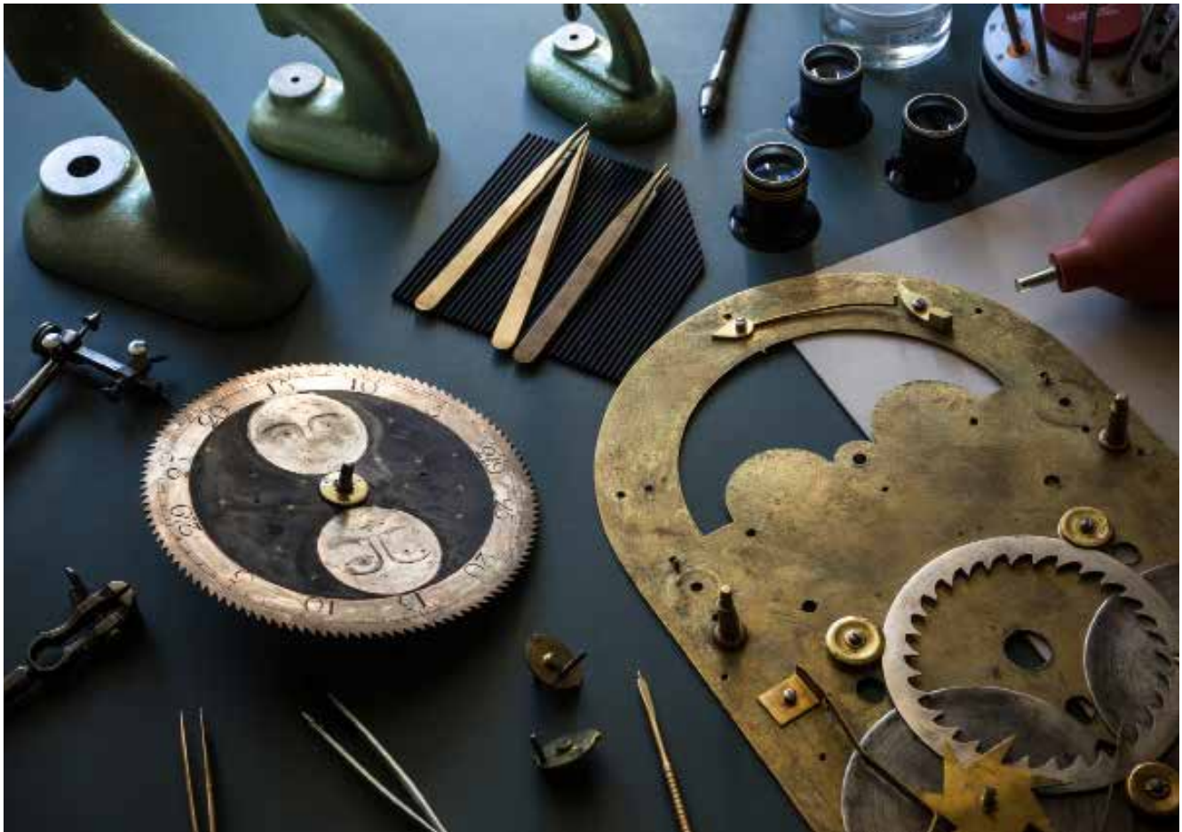
Dismantling the rear dial mechanism on an English clock (18 th century) by Robert Dalsen, London. The calendar shows the day of the week, date, month, and phases and age of the Moon. Démontage du mécanisme arrière du cadran d'une pendule anglaise (XVIII e siècle), signée Robert Dalsen, London. Son calendrier indiquait le jour de la semaine, la date, le mois, les phases et l'âge de la Lune.
